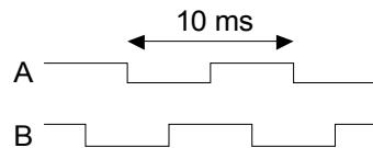
1-1- En déduire la vitesse de rotation du moteur (en tr/min).
