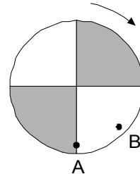
Les capteurs optiques A et B donnent en sortie un niveau logique 1 en présence de blanc, et 0 en présence de noir :
