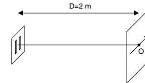
Sur la figure 3, on observe à la fois le phénomène de diffraction par les fentes et celui d'interférence entre les deux fentes :
