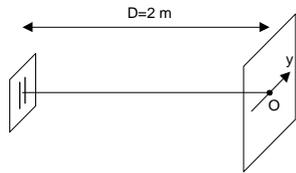
Un détecteur photoélectrique permet de mesurer l'intensité lumineuse de la lumière à la position  $y$  de l'écran : on observe un phénomène d'interférence caractérisé par une succession régulière de franges brillantes et sombres (voir figure 1).
